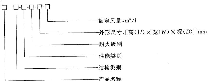
图 2 过滤器型号规格表示方法
