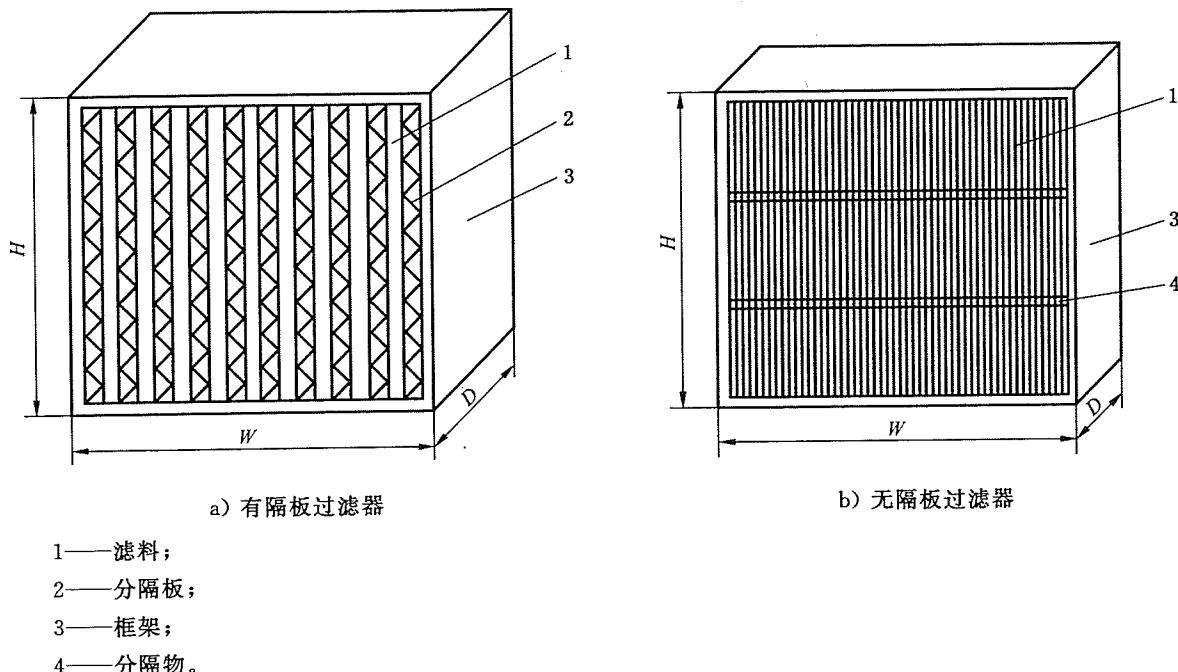
图 1 有隔板过滤器和无隔板过滤器
