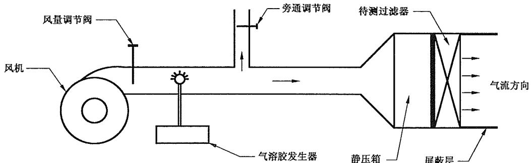
图 C.1 扫描检漏试验系统示意图
